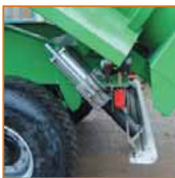
Pare-chocs escamotable par 2 vérins pneumatiques à commande manuelle.
